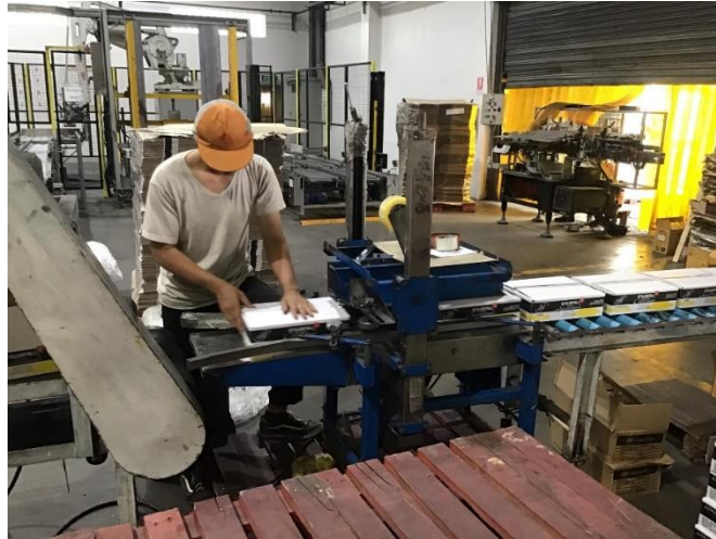
ภาพ 5.13 กระบวนการปิดผนึกกล่องสินค้า
