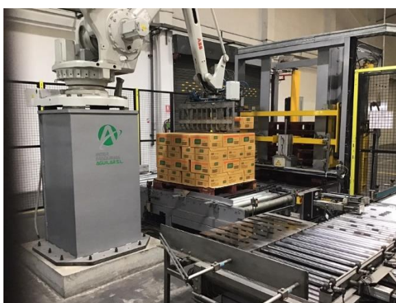
ภาพ 5.25 หลังนำเครื่องจักรเข้ามาช่วยในกระบวนการทำงานมีความต่อเนื่องลดความเหนื่อยล้าของพนักงานทั้งยังสามารถลด
