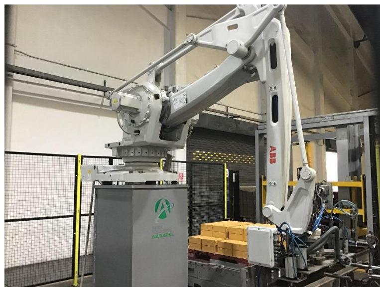
ภาพ 5.22 เครื่องจักรที่ใช้ยกสินค้าลงพาเลตแทนคนงาน
